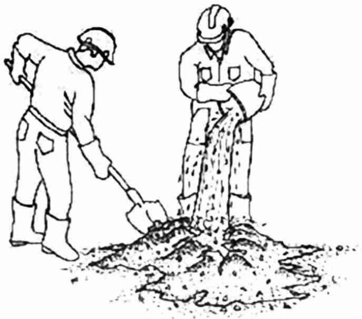
*Figura 2.2: Producción manual de concreto*
