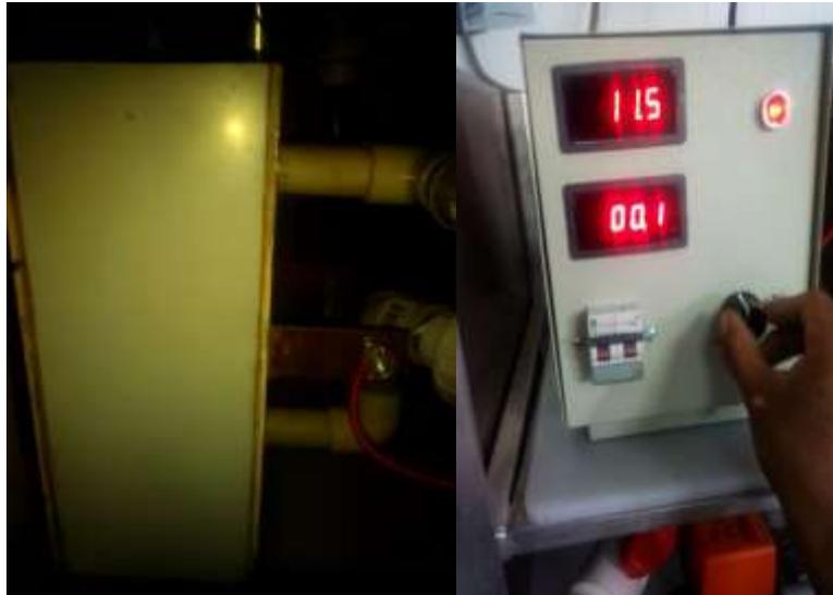
**FIGURA N° 05: IONIZADOR DE AGUA EN DONDE SE DA EL PROCESO DE ELECTROLISIS OBSERVESE EL CONTROLADOR DE AMPERAJE DEL IONIZADOR**
