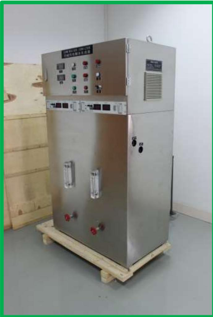
Ionizador donde se realizará el tratamiento de electrolisis con control de amperaje
