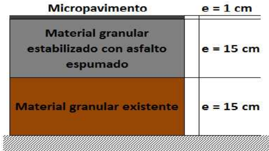
Figura 23: Solución Alternativa 1 - para Cumplimiento Estructural Hasta 2017
