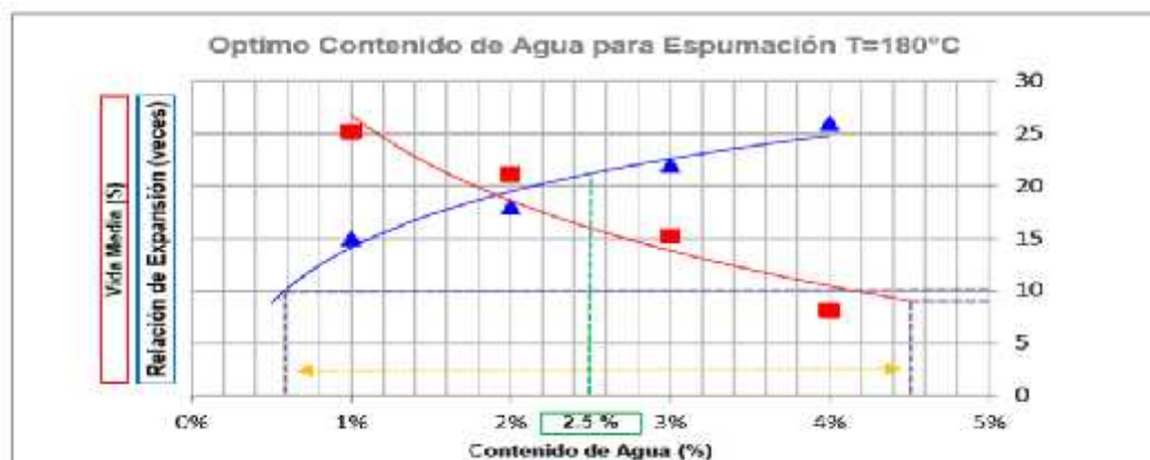
Figura 26: Determinación de óptimo Contenido de Agua de Espumación para T= 180°C
