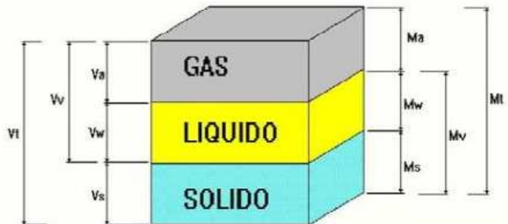
Figura 5: Esquema de una muestra de suelo, con sus partes principales
