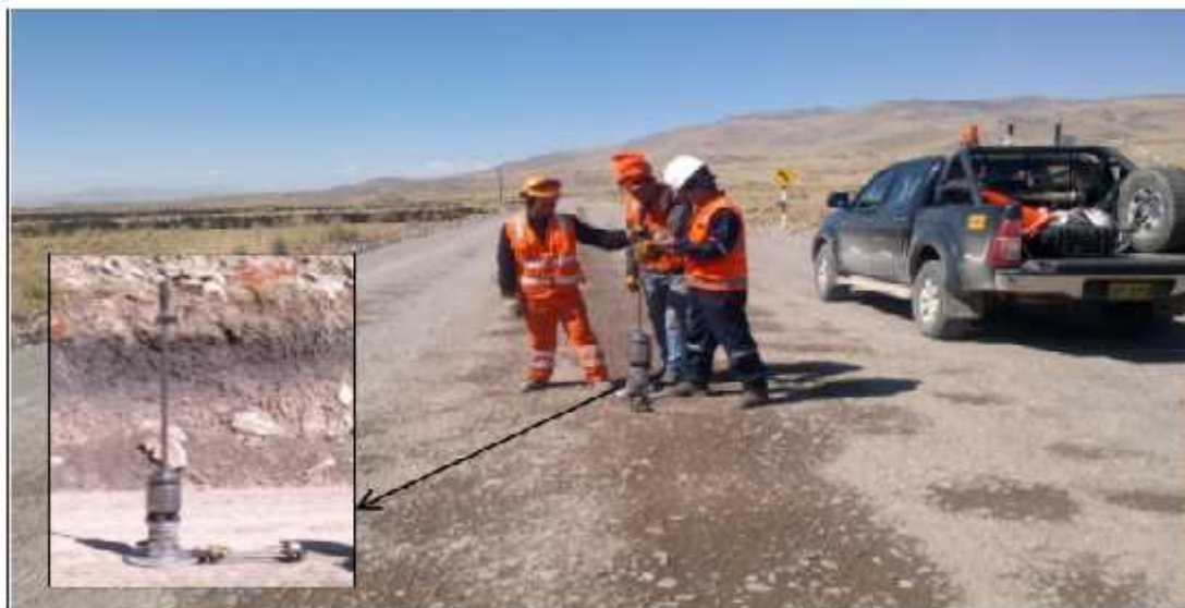
Figura 14: Mediciones de Deflectometría
