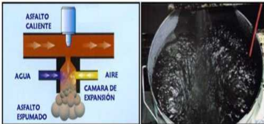
Figura 24: Izquierda - Simulación del Proceso de Espumación - Muestra de Asfalto Espumado
