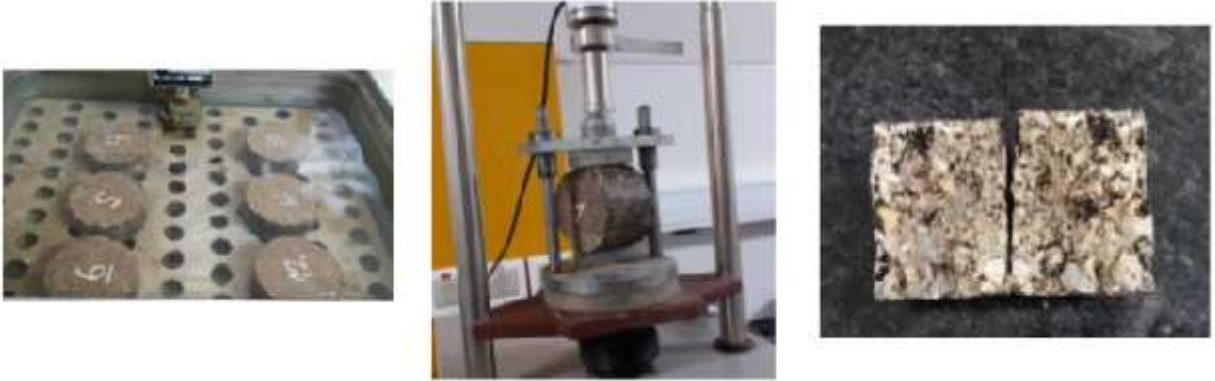
Figura 30: Procesos Curado y Rotura Mediante Tracción Indirecta
