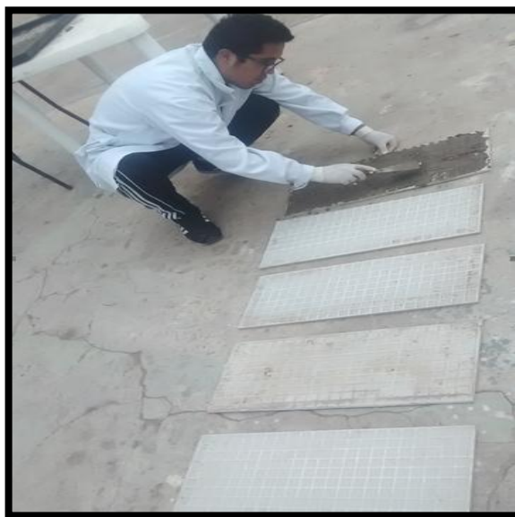
Figura 3.9. Recubriendo con la mezcla las superficies para la experimentación
