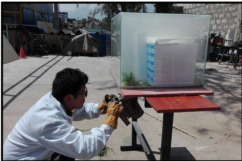
Figura 3.14. Introduciendo gases de combustión a las cabinas
