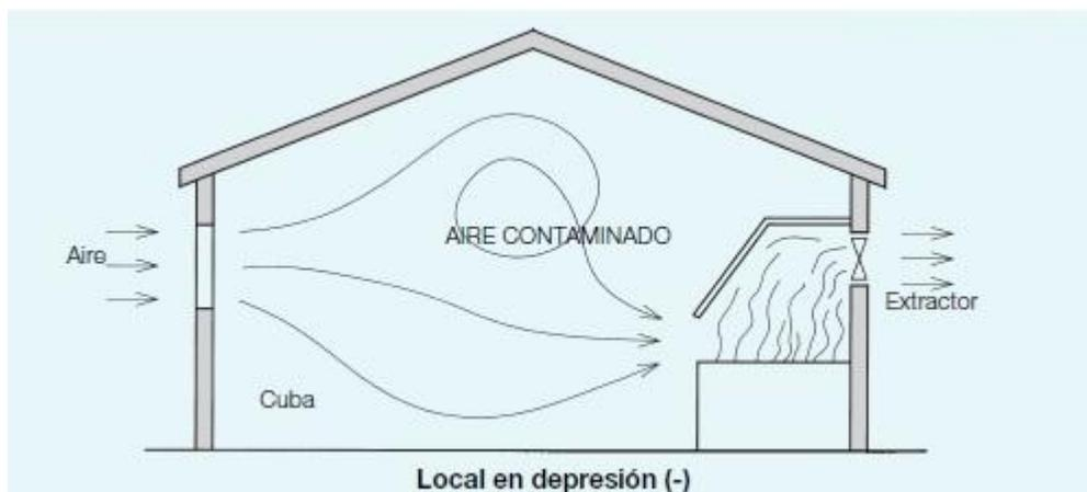
Figura 26. Ventilación ambiental localizada en depresión. Recuperado de <https://www.salvadorescoda.com/tecnico/VE/Manual-Ventilacion.pdf>
