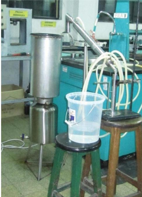
**Figura 18.** Maquinaria de destilación de arrastre para obtener el aceite esencial de *Thymus vulgaris*.
