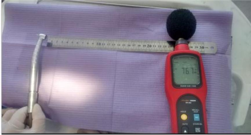
**Foto 3: Medición de la pieza de mano a una distancia de 25 cm al sonómetro**
