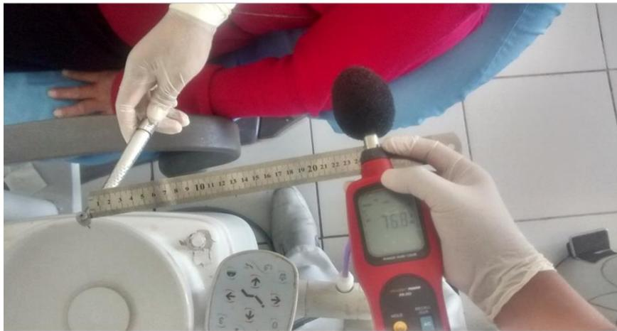
**Foto 4: Medición de la pieza de mano a una distancia de 25 cm al sonómetro con la colaboración de alumno.**
