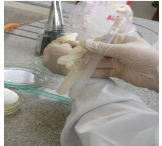
Fotografía 07: Comparación de la turbidez equivalente al tubo N° 0.5 de la escala de Mac Farland ( 1.5 \times 10^8 UFC/ml)
