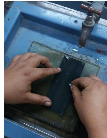
Imagen 2: Lijado de piezas para obtener una base estable.
