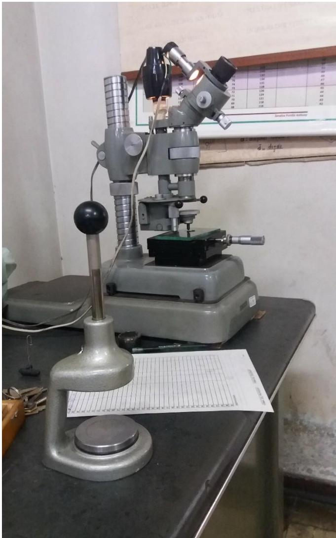
Imagen 3: Microdurometro.
