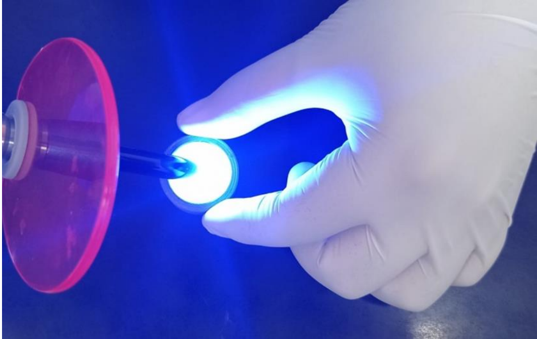
Figura 3. Fotopolimerización de cilindros de resinas Bulk Fill.
