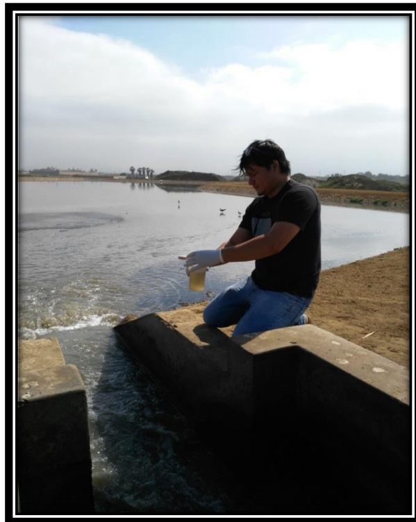
Foto N° 02: “TOMANDO LAS PRIMERAS MUESTRAS EN LOS EFLUENTES DE LAS LAGUNAS DE ESTABILIZACIÓN DE LAS TORRES DE SAN BORJA – MOCHE”
