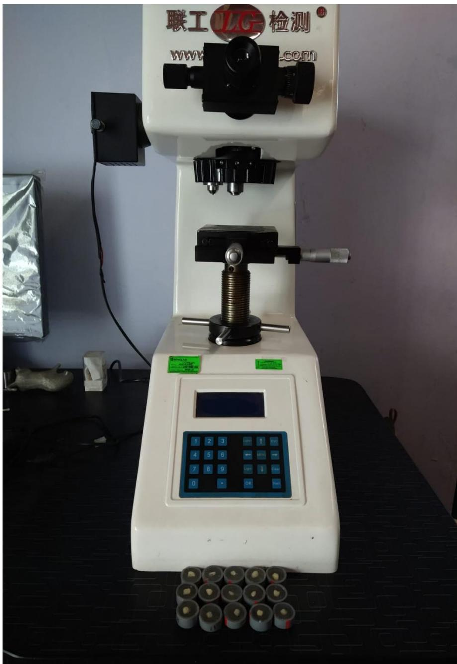
Observamos aquí las muestras enumeradas de la marca Olimpyc ya en el sujetador para ir directo al microdurometro
