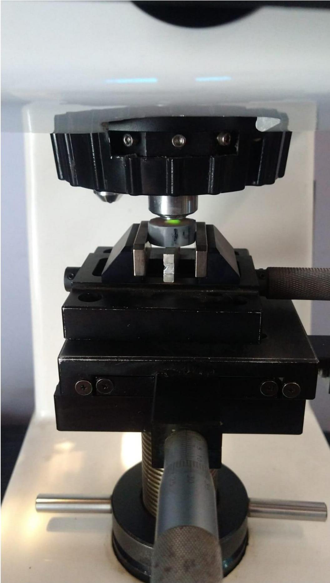
Vista a través del microdurometro donde podemos ver la muestra dental indentada (Forma romboide) de la marca Gnathostar
