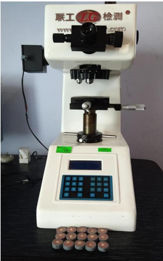
Tenemos aquí el microdurometro LG y las muestras de la marca Olimpysc
