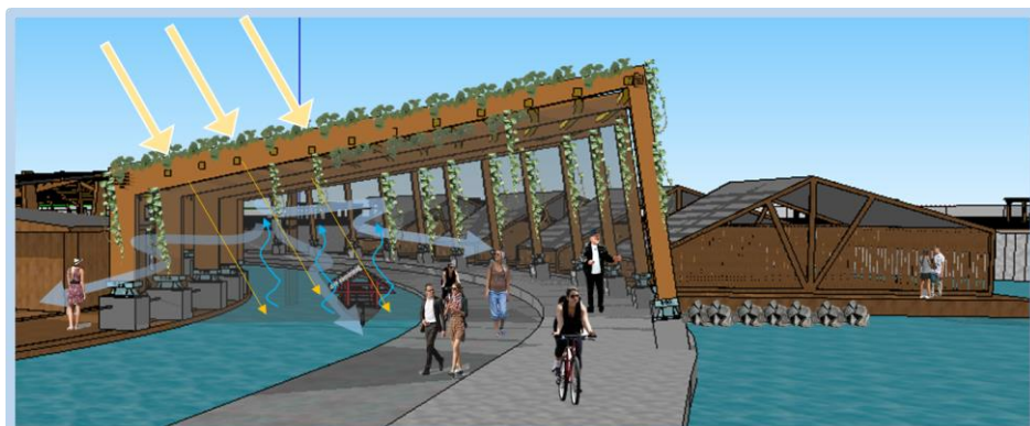
Ilustración 27: microclima húmedo por la radiación solar y viento
