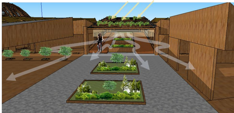
Ilustración 26: clima fresco producto del efecto Venturi en espacios estrechos y por la protección solar.
