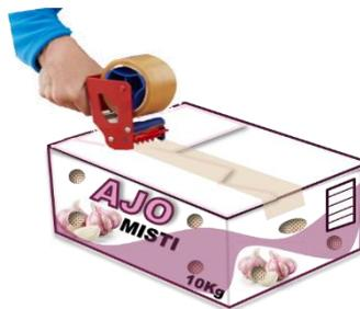
Después del cerrado de los envases, se procederá a embalar los mismos con la cinta con adhesivo acrílico fabricada en polipropileno. Para este proceso se utilizará una precintadora manual.
