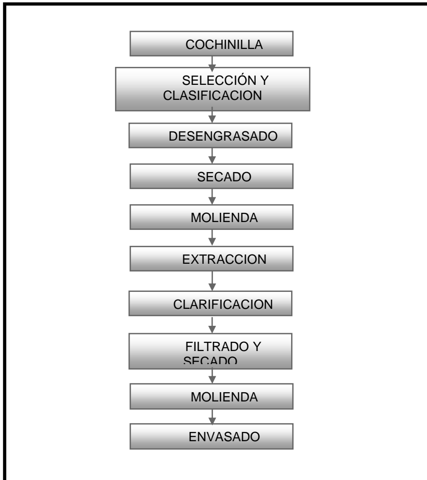
Figura 2 Flujo grama de proceso del carmín de cochinilla
