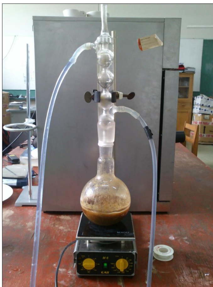
Figura N° 3.4: Activación del bioadsorbente
