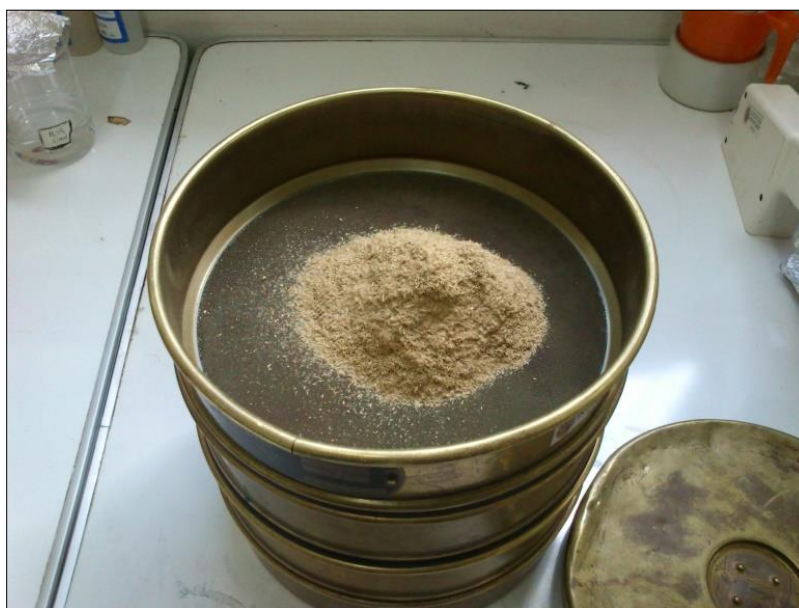
Figura N° 3.8: Tamizado del bioadsorbente
