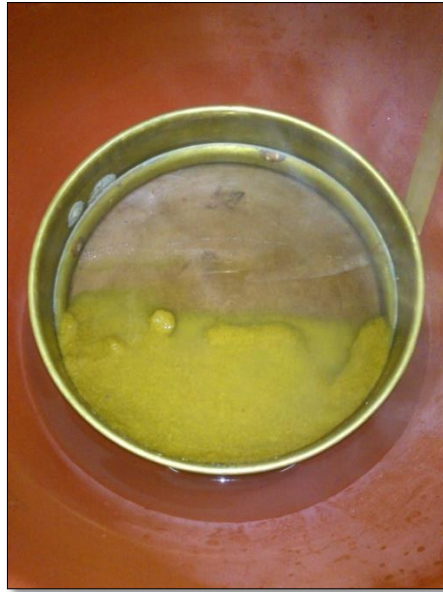
Figura N° 3.5: Lavado del bioadsorbente
