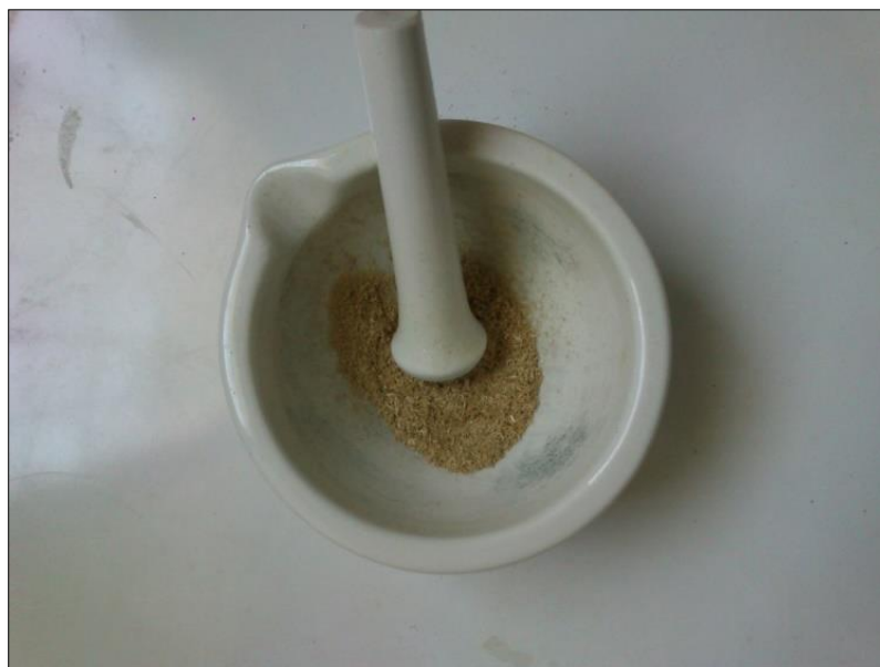
Figura N° 3.7: Molienda del bioadsorbente activado
