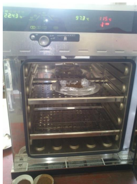
Figura N° 3.6: Secado del bioadsorbente
