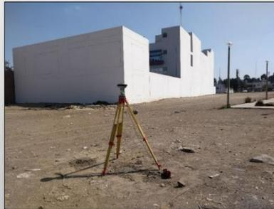
Realizado el post proceso con el Software LGO se calcularon las coordenadas UTM en Datum WGS84 Zona: 18Sur.
