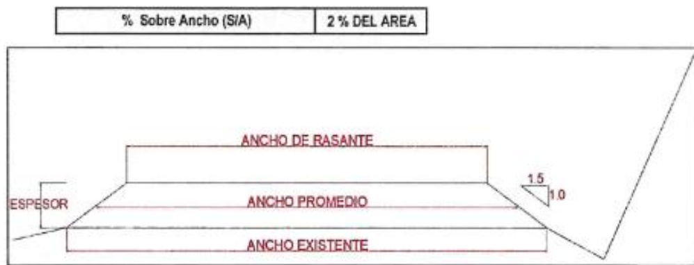
Figura 5: Estructura del camino vecinal
