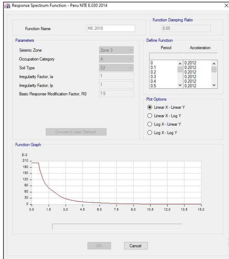
Gráfico 23: Espectro inelástico de pseudoaceleraciones para sistema estructural de muros estructurales.
