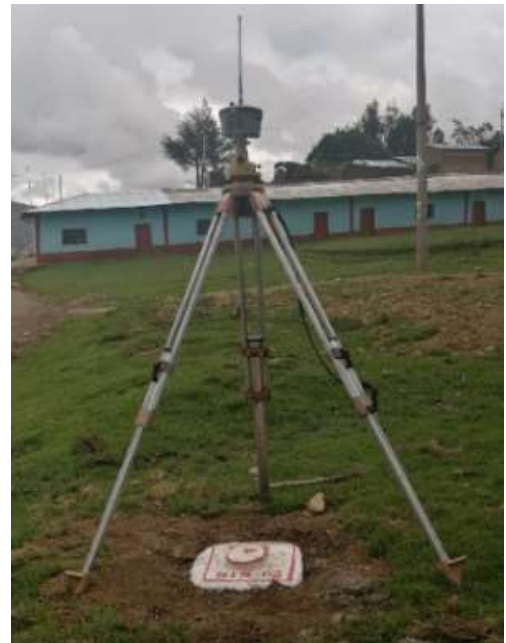
Ilustración 18 - Lectura del Punto Geodésico de Orden C
