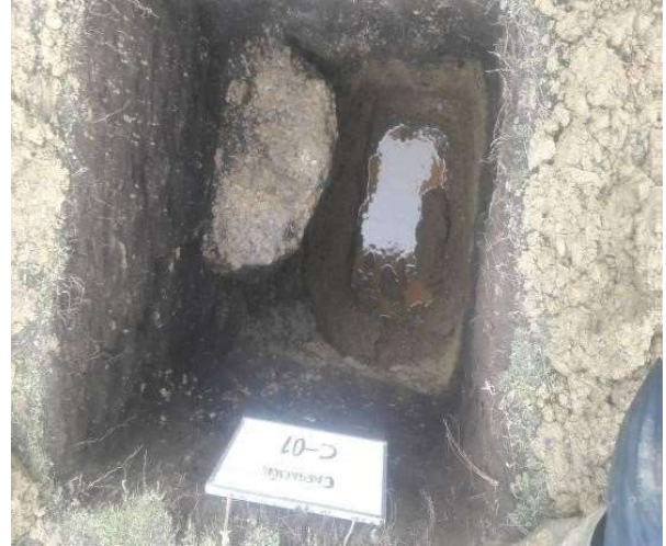
Ilustración 2 - Calicata 01 Estratos (Captación)
