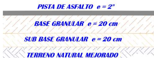
Gráfico 4. Detalle de Pavimento
