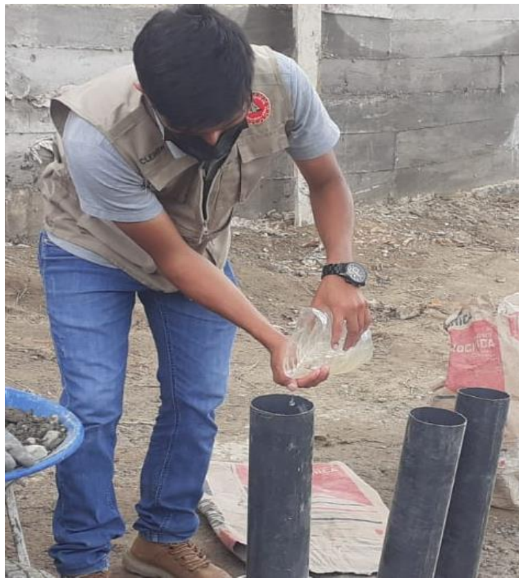
Foto 06. Medición de la altura del concreto poroso para determinación de permeabilidad
