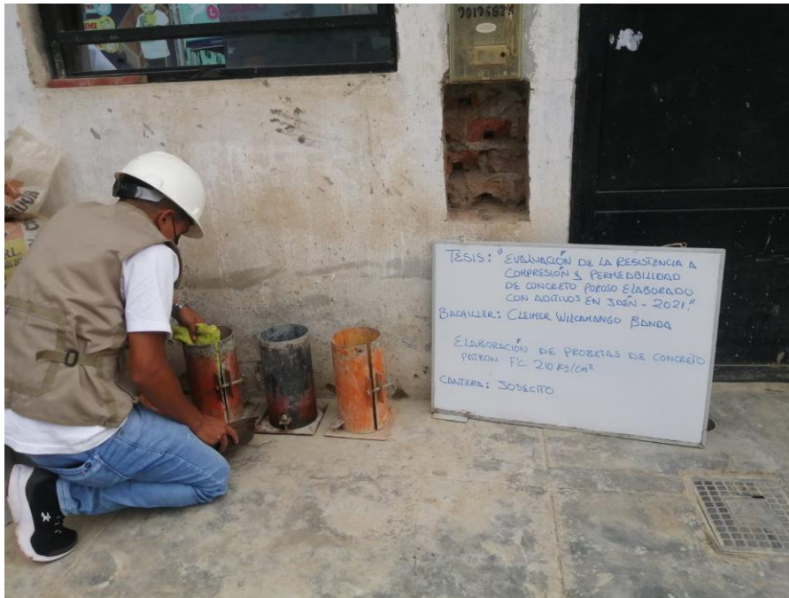
Foto 03. Elaboración de probetas de concreto poroso
