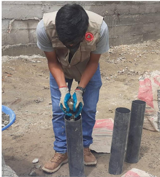
Foto 06. Llenado del concreto en el molde de tubo PVC de 4" y 50 cm de longitud
