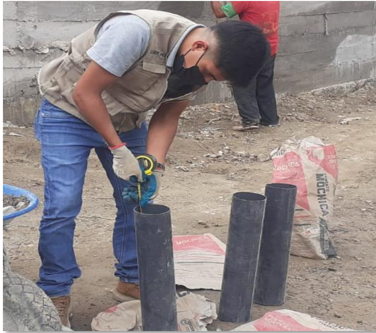
Foto 06. Medición de la altura del concreto poroso para determinación de permeabilidad
