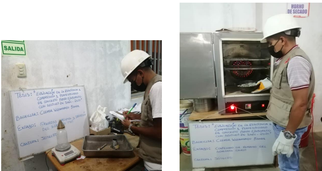
Foto 02. Ensayo de gravedad específica, absorción y humedad del agregado
