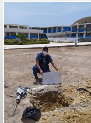
Foto N°01: Vista de ubicación de la calicata C-01, en su parte superficial presencia de material arena arcillosa de 0.05m
