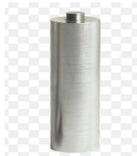
Figura N°6. Pistón de penetración
