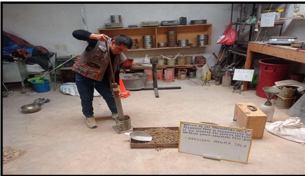
Figura N°19. Proceso de compactación, para los ensayos de Proctor modificado
