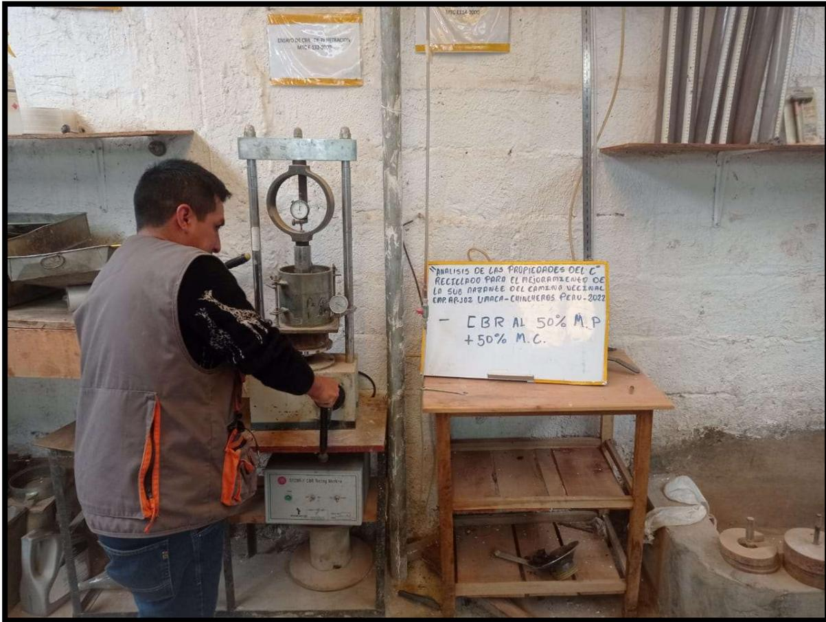
Figura N°20. Proceso de punzonamiento o sometimiento de esfuerzo correspondientes a las dosificaciones de 50% material de concreto reciclado y 50% de material de préstamo.
