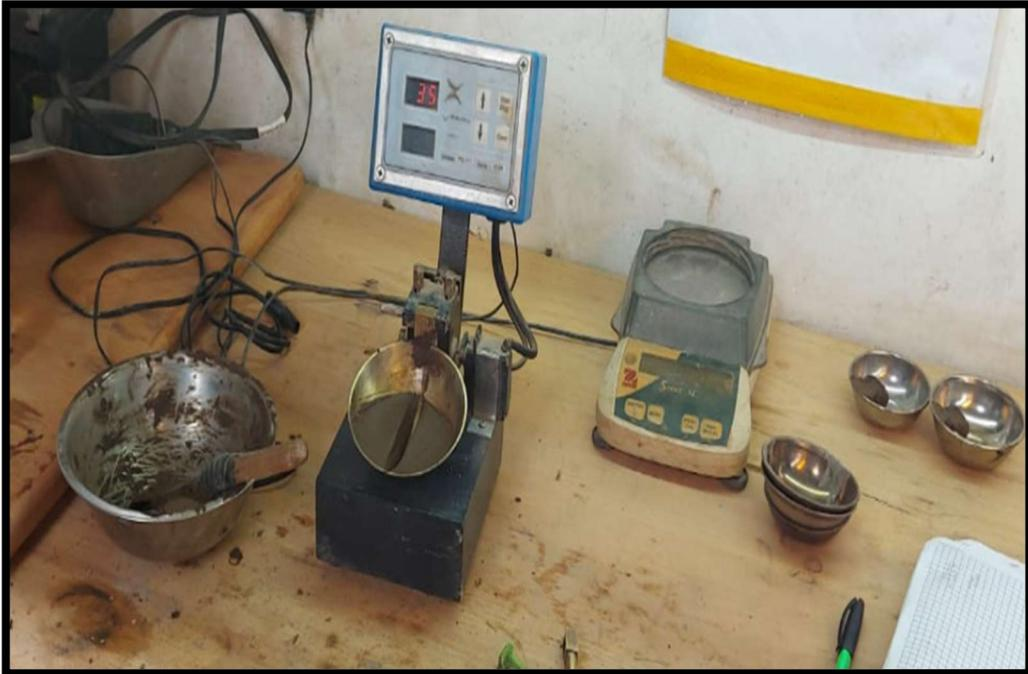
Figura N°16. Realización del ensayo limite liquido de la muestra natural.
