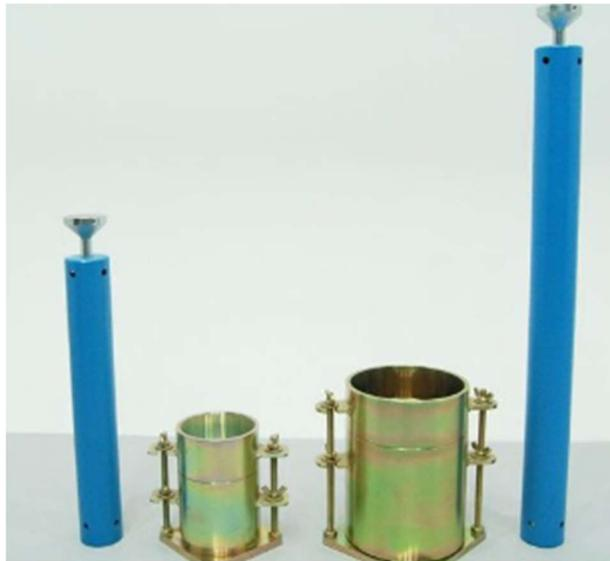
Figura N°8. Moldes y equipos para Proctor Modificado
