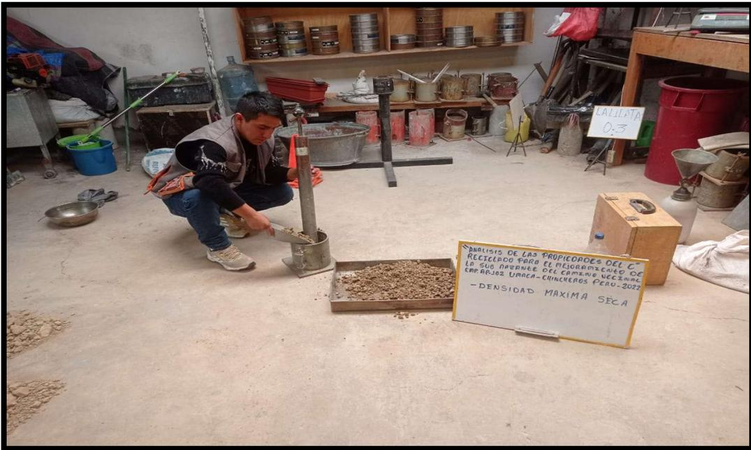
Figura N°18. Proceso de compactación, para el ensayo de Proctor modificado.
