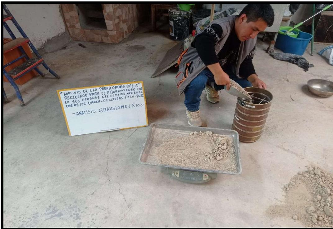
Figura N°13. Método del zarandeado para la separación de los materiales, en tamaños.
