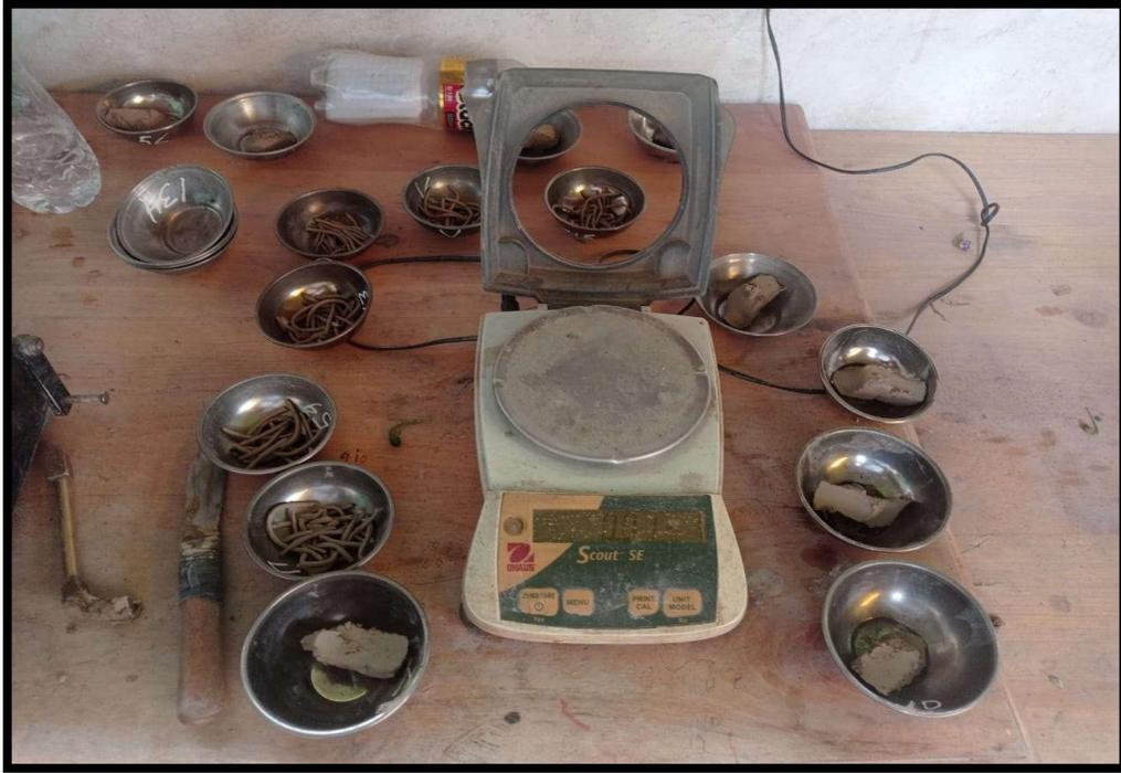
Figura N°14. Realización del ensayo limite liquido de la muestra natural.
