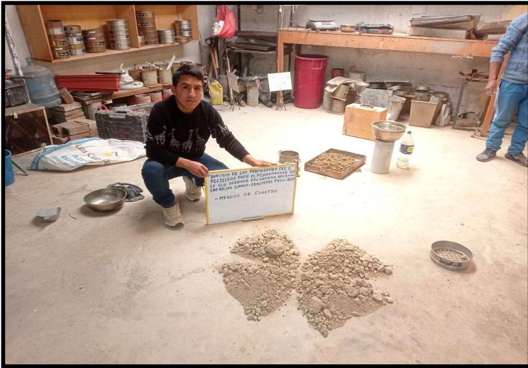
Figura N°12. Método del cuarteo para obtener unas muestras con tamaños adecuados.
