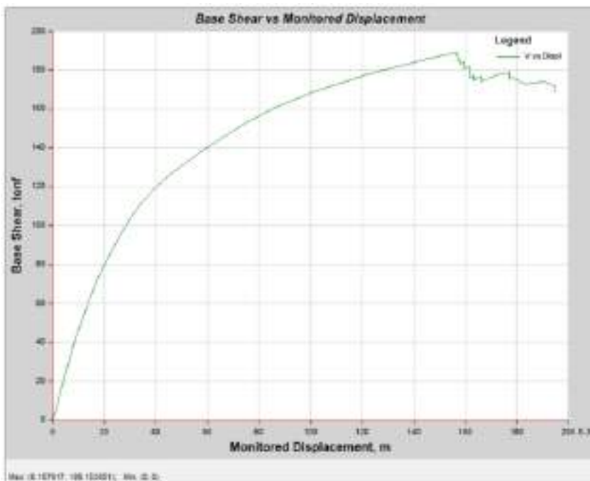
Figura 65. Curva de capacidad de la estructura
