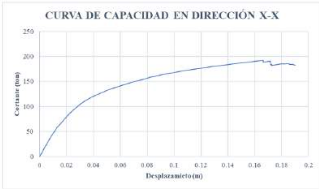
Figura 86. Curva de capacidad de la estructura en la dirección x-x
