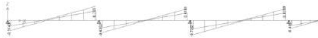
Figura 28. Diagrama de fuerzas cortantes en la losa aligerada
