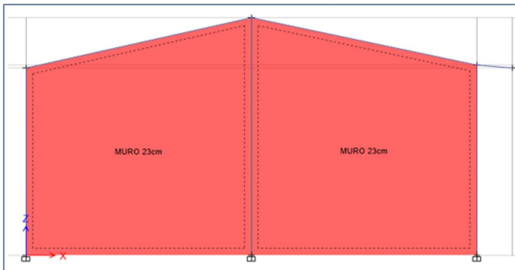
Figura N° 28: ETABS, Ubicación de Muro de Albañilería en Pórtico del Eje Y-Y.
