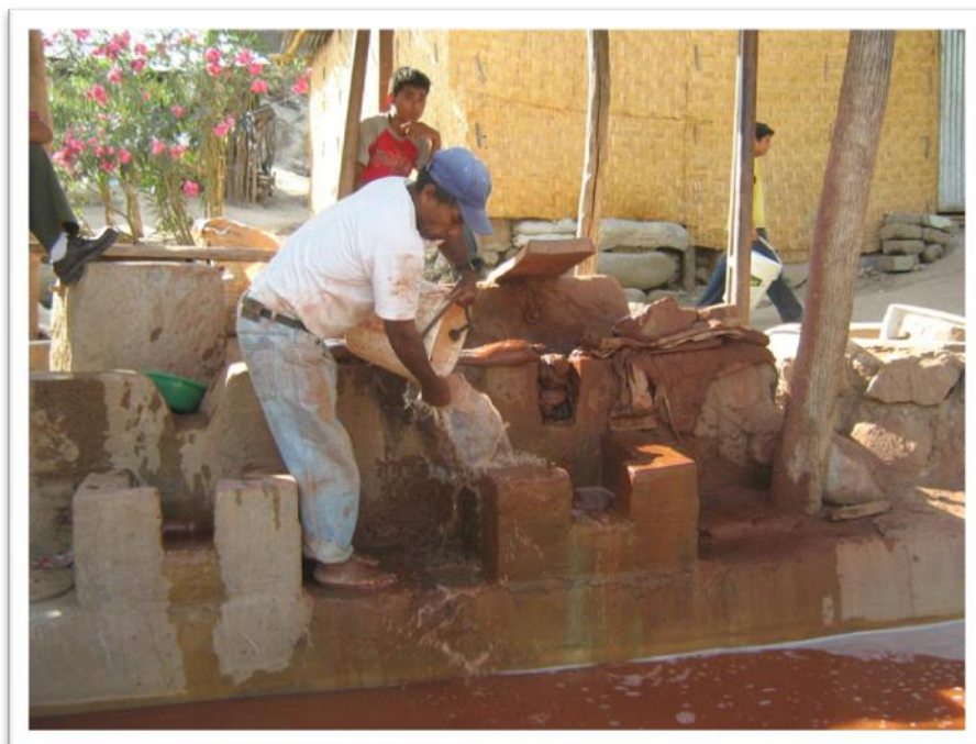
FOTO N° 05: El relave es desaguado a canchas.
