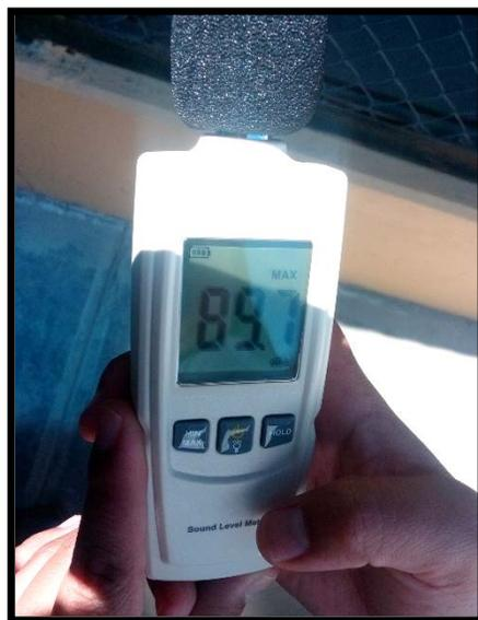
Lectura de NPS ocasionado por la compresora con el sonómetro.
