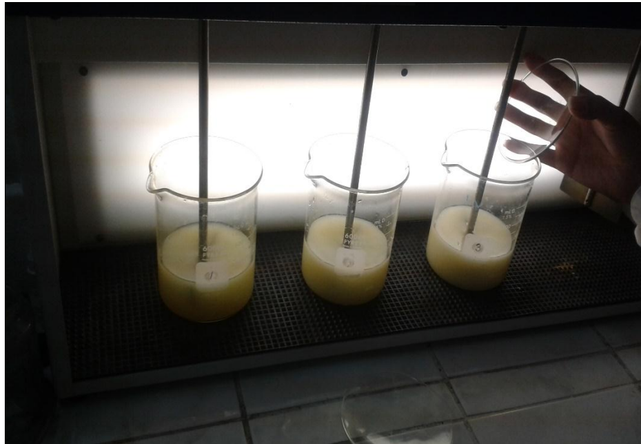
Figura 4.28 Adición de Cloruro de Bario en la Prueba de Jarra.
