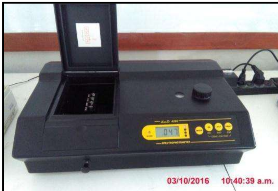
Imagen N° 11: Lectura de la absorbancia del mosto de vino en el espectrofotómetro.
