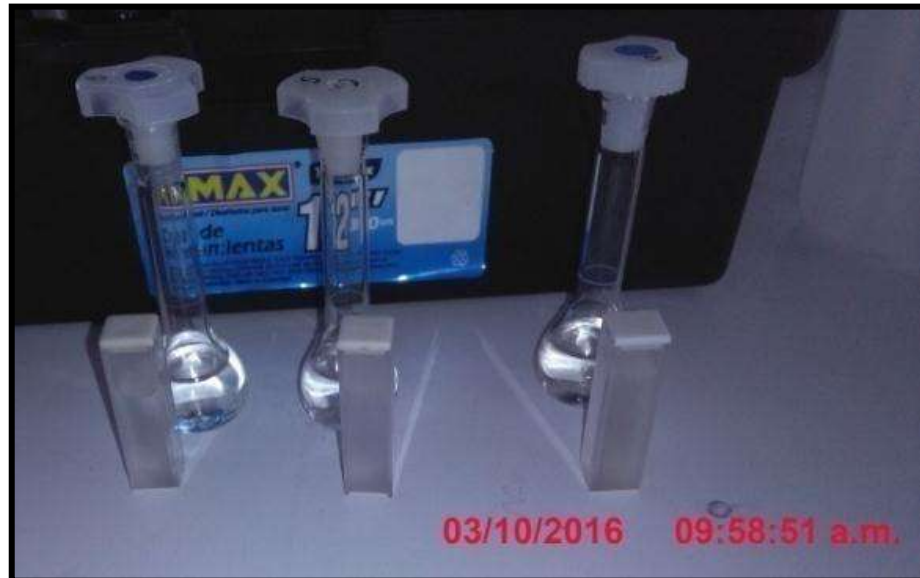
Imagen N° 13: Muestras listas de la gelatina para ser leída en el espectrofotómetro.
