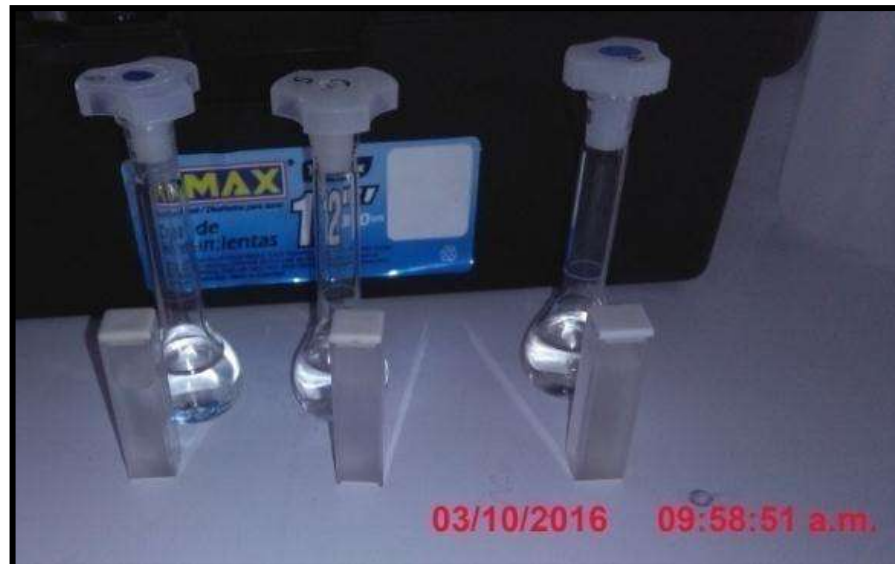
Imagen N° 9: Muestras listas del polvo de mosto de vino para ser leída en el espectrofotómetro.
