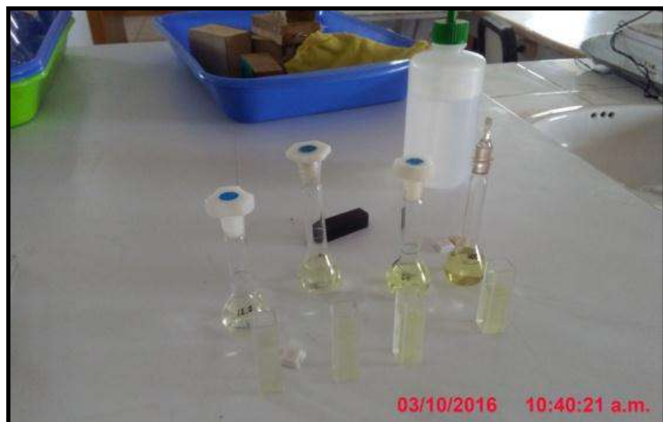
Imagen N° 10: Muestras listas de quercetina patrón para elaborar la curva de calibración en el espectrofotómetro.
