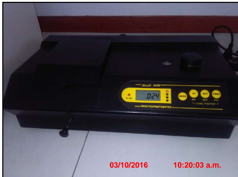
Imagen N° 14: Espectrofotómetro con la absorbancia leída.
