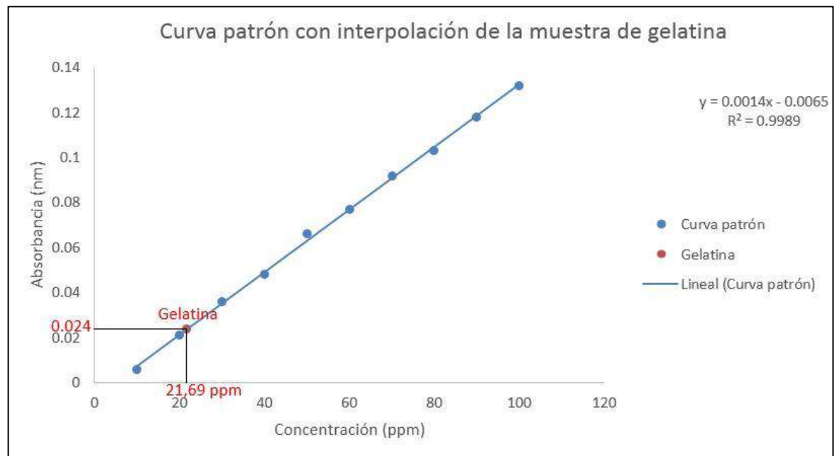
Gráfico N° 2: Curva patrón con la interpolación de la muestra de gelatina
