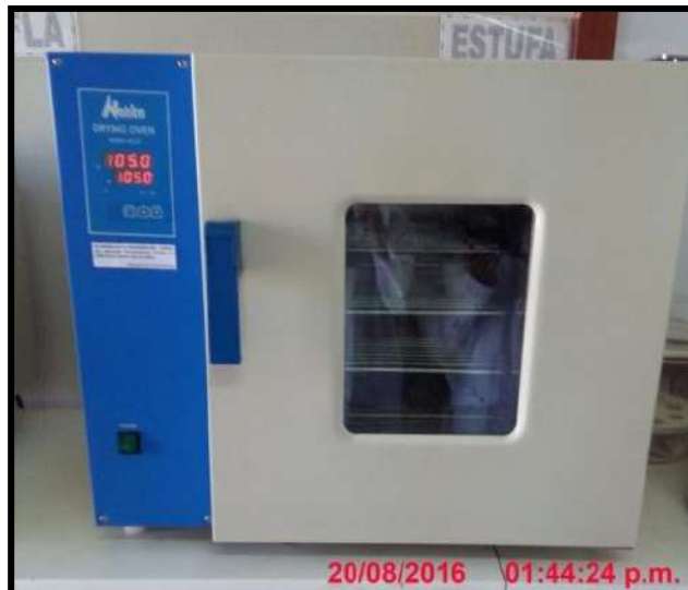
Imagen N° 4: Muestra en la estufa para secado de mosto y determinación de humedad.
