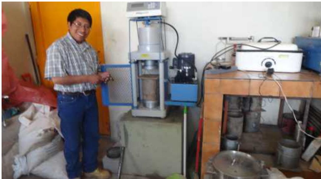
FOTO 8.- PREPARACIÓN PARA EL ENSAYO A FLEXIÓN
