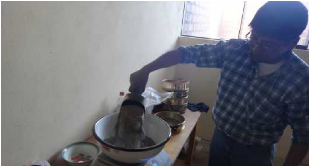
FOTO 2.- PESADO DEL AGREGADO
