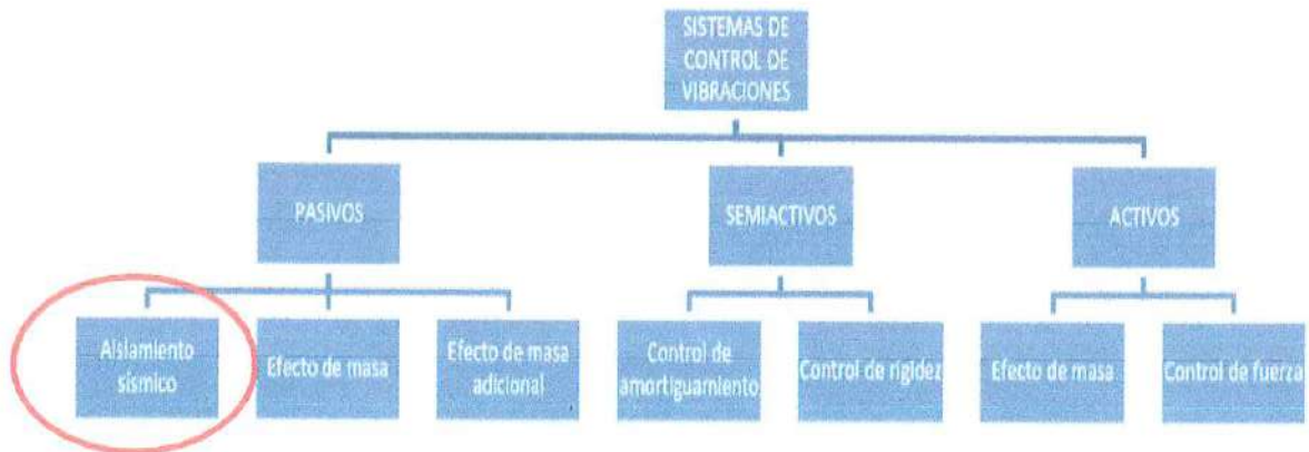
Figura 1.1.- Clasificación de sistemas de respuesta sísmica
