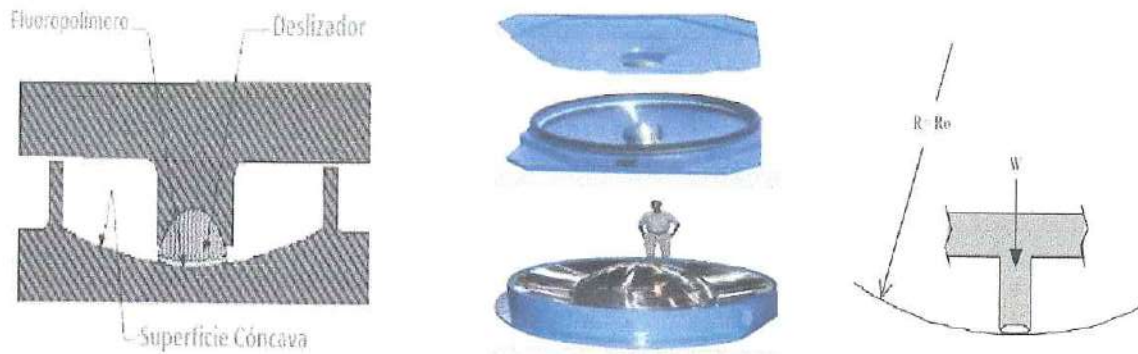
Figura 2.7- Componentes del aislador FPS y Deslizador sobre superficie esférica Fuente: Norma NCh 2745
