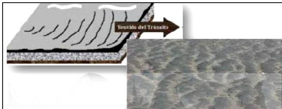
Figura II.6. Daño por corrimiento
