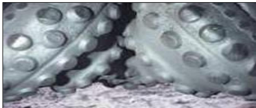
Figura 18: Desgaste plano. Fuente: Becerra, (2014).
