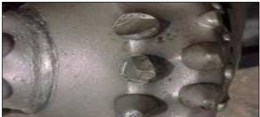
Figura 16: Inserto fragmentado. Fuente: Becerra, (2014).
