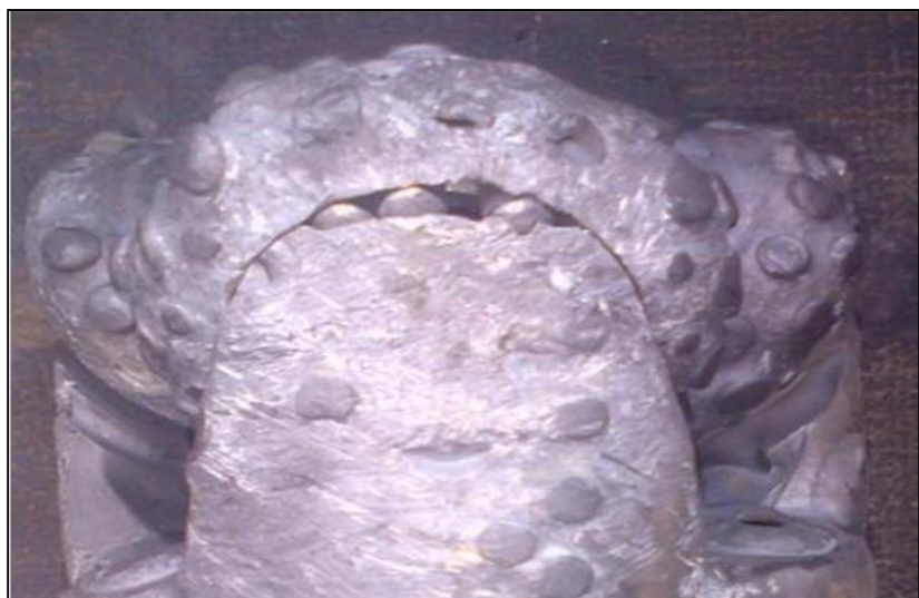
Figura 24: Daño de faldón. Fuente: Becerra, (2014).
