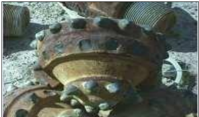
Figura 11: Insertos rotos. Fuente: Becerra, (2014).
