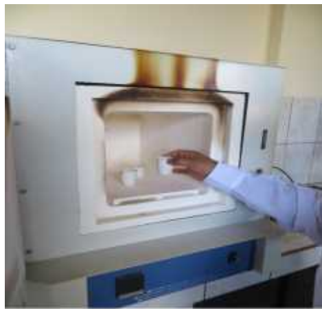
Fig.14. Mufla para incinerar las muestras
