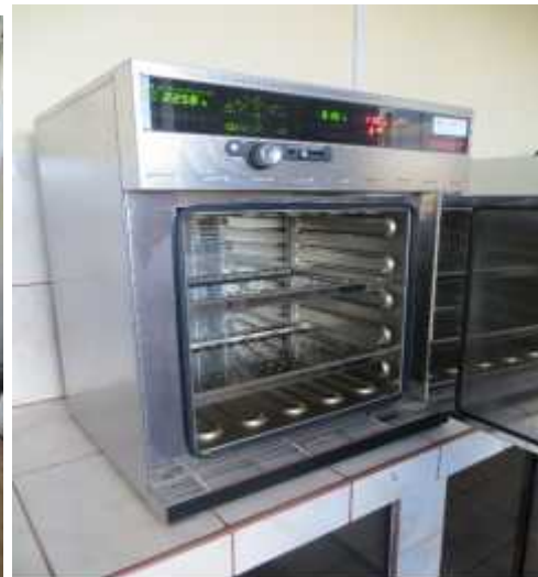
Fig.11. Estufa para deshidratación
