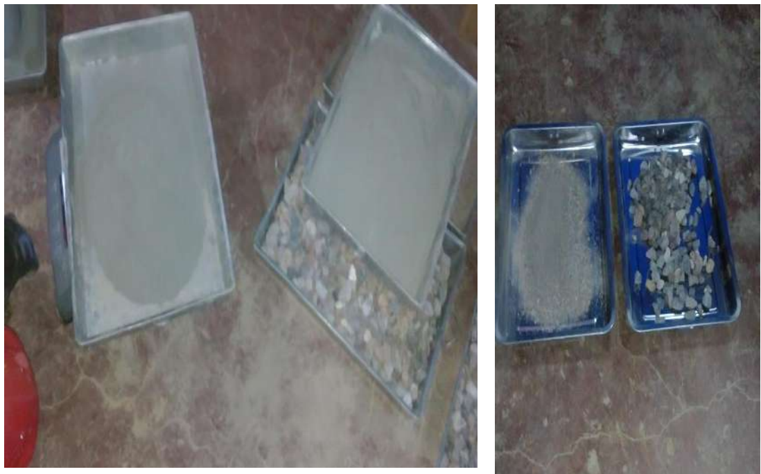
GRAFICO 13: Secado de la muestra hasta el estado SSS Con una secadora
