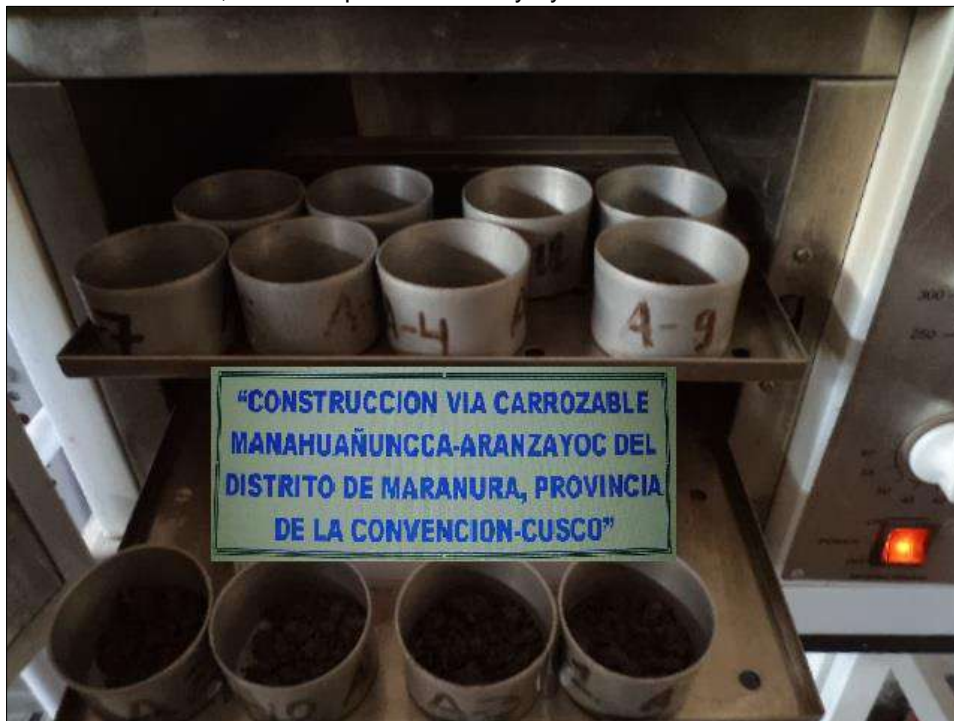
Fotografía N° 28: Ensayo de Determinación del Contenido de Humedad realizado a las muestras N° 01, 02, 03, 04, 05 y 06 del Estudio.
