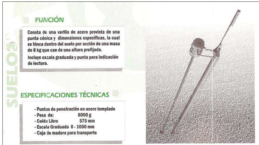
Figura N° 04, Descripción del equipo de PDC para la determinación de CBR de campo
