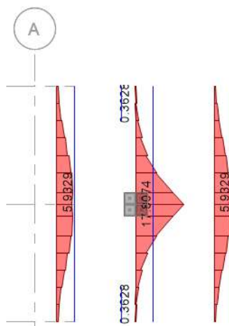
Figura 4.30. Diseño por flexión del modelo 1 para la dirección YY.
