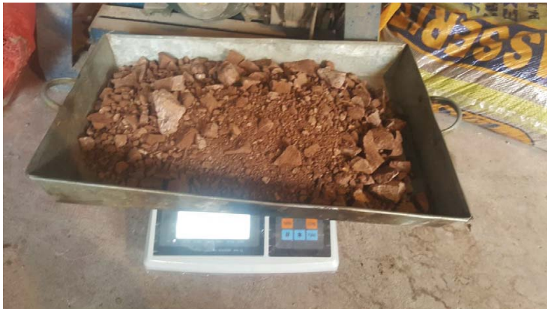
Fotografía 06: Ensayo de laboratorio (granulometría)
