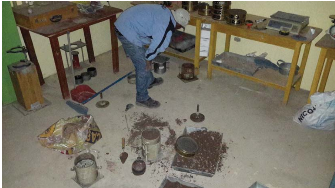
Fotografía 05: ensayos en laboratorio de suelos (CBR)
