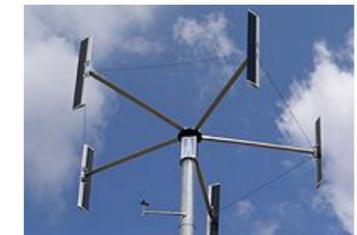
Dependiendo de los vientos y de la potencia necesaria, se instala el aerogenerador Roble, que nos puede mover bombas "standard" desde 0,5 cv. a 7,5 cv.
