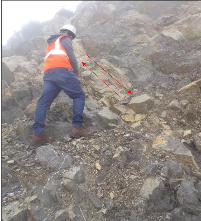
**Figura 10:** Calizas de la formación Cajamarca con alteración por falla geológica.
