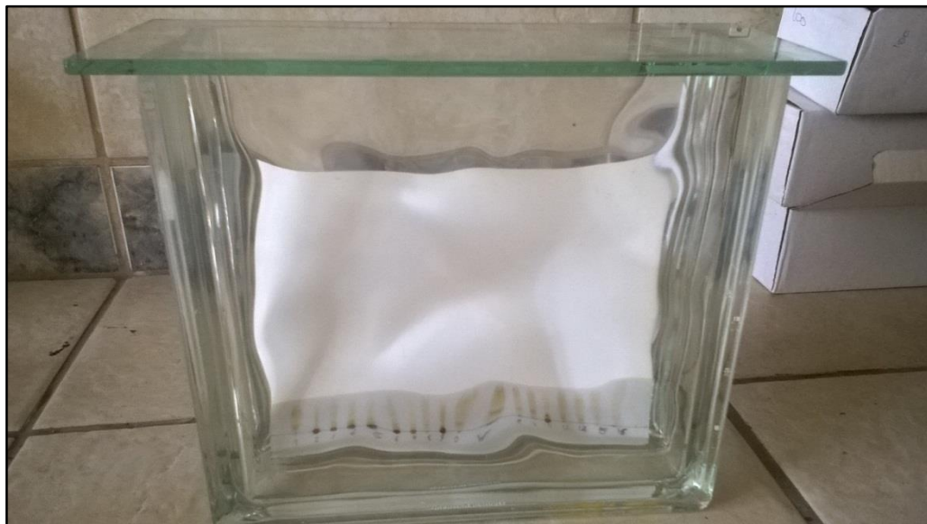
FOTO N° 5 Desarrollo de la cromatografía. Fase móvil: n-Butanol : ác. Acético : Agua
