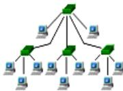
Esta estructura de cableado se utiliza en la mayor parte de las redes locales actuales, por medio de concentradores dispuestos en cascada para formar una red jerárquica.
