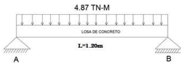
Fig. Nro. 24: Losa aplicado a carga
