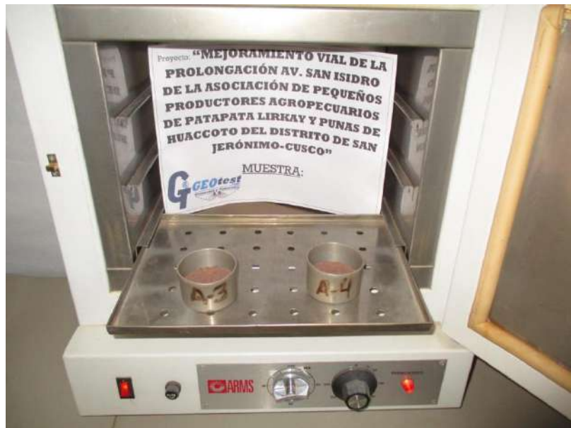
Figura Nº 27 - ENSAYOS DE LABORATORIO Vista del Ensayo de Determinación del Contenido de Humedad realizado a las muestras del Estudio.
