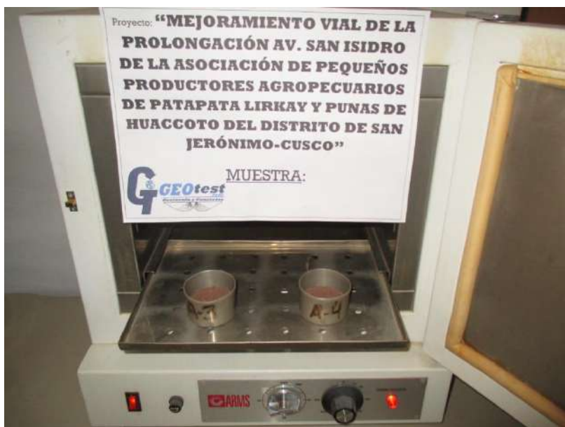
Figura Nº 25 - ENSAYOS DE LABORATORIO Vista del Ensayo de Determinación del Contenido de Humedad realizado a las muestras del Estudio.
