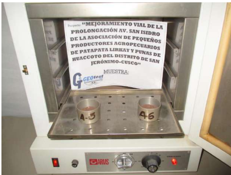
Figura N° 29 - ENSAYOS DE LABORATORIO Vista del Ensayo de Determinación del Contenido de Humedad realizado a las muestras del Estudio.
