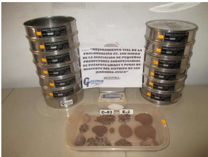
Figura N° 30 - ENSAYOS DE LABORATORIO Vista del Ensayo de Análisis Granulométrico realizado a la muestra del Estudio.
