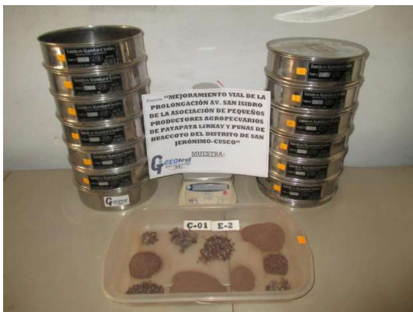
Figura Nº 26 - ENSAYOS DE LABORATORIO Vista del Ensayo de Análisis Granulométrico realizado a la muestra del Estudio.
