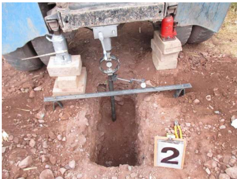
Figura N° 16 - POZO N° 02 Vista del Ensayo de CBR In Situ realizado en la calicata.
