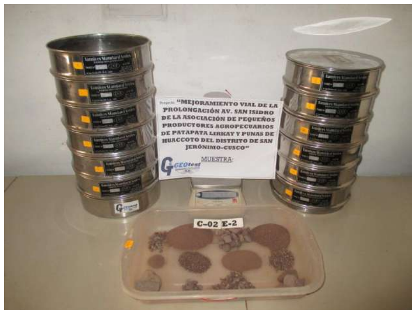
Figura Nº 28 - ENSAYOS DE LABORATORIO Vista del Ensayo de Análisis Granulométrico realizado a la muestra del Estudio.
