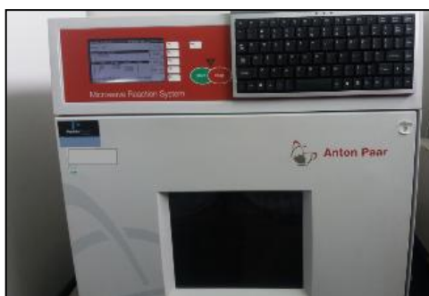
Figura N° 06 Equipo de digestión por microondas
