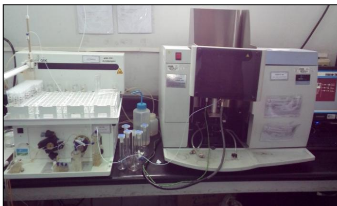
Figura N° 07 Equipo de espectrofotometría de absorción atómica
