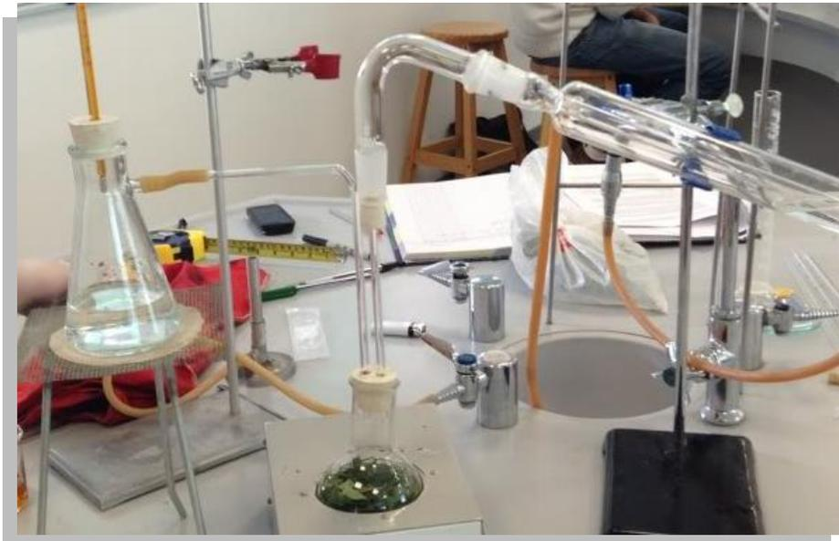
FOTO N° 02: Instrumentos de destilación de arrastre a vapor para obtener el aceite esencial de *Luma Chequen* “Arrayán
