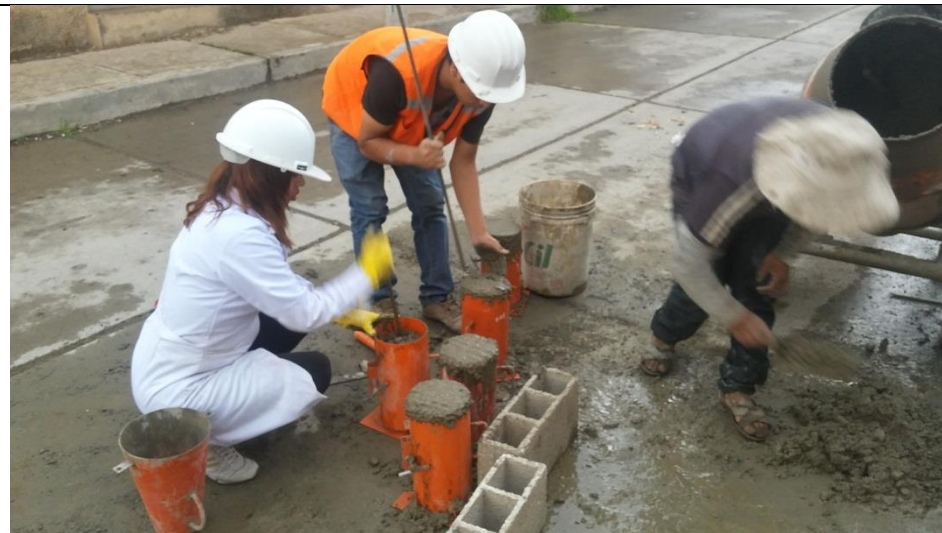
La fotografía evidencia la elaboración de briquetas de concreto.
