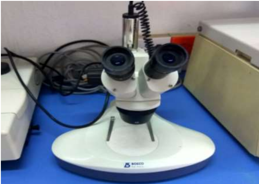
Foto 7: Estereoscopio con lentes de aumento de 4x marca BOECO.
