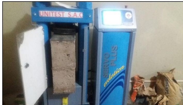
Ensayo a compresion axial de pilas de albañileria
