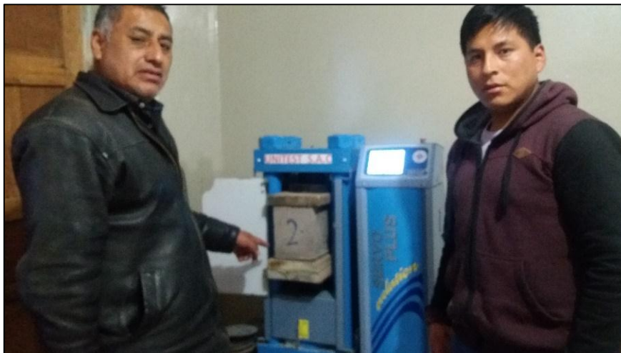
Verificación de ensayo a compresion de los bloques.
