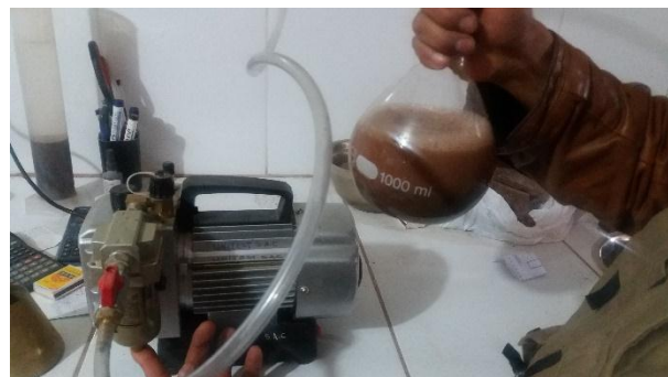
Eliminación mecánica de aire atrapado, dentro del Picnómetro.
