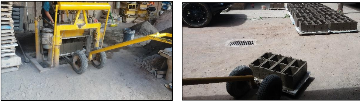
Foto 5. Desmoldado de los bloques.
