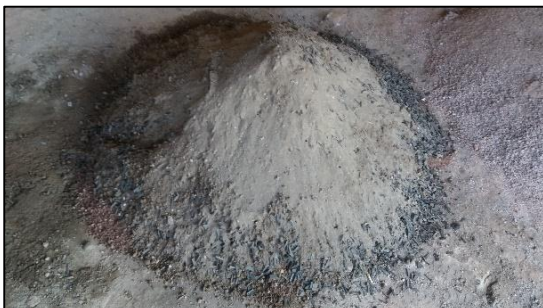
Foto 2. Mezclado del agregado con fibras de caucho
