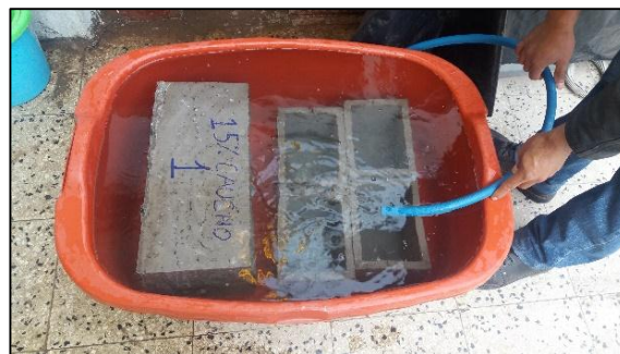
Foto 10. Secado en horno por 24 horas y sumergido en agua por 24 horas.
