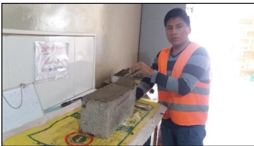
Refrentado de base con capping.
