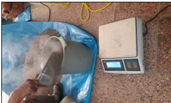
Vertido y compactado del material.
