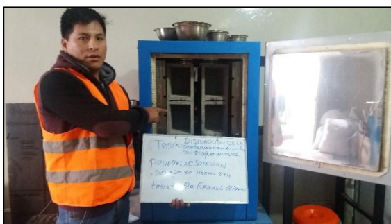
Foto 10. Secado en horno por 24 horas y sumergido en agua por 24 horas.
