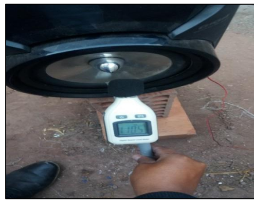
Lectura del sonido patron en el punto medio del prototipo.
