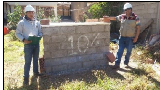
Lectura de datos en paredes exteriores 0 y 10%, prototipo con techo.
