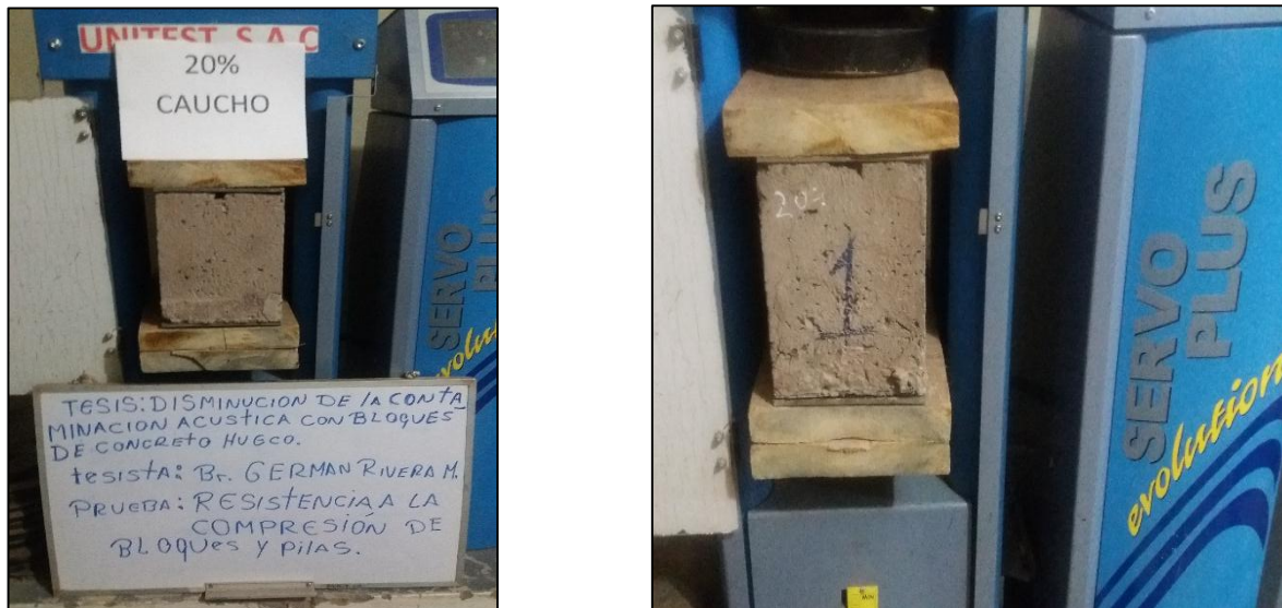
Foto 12. Colocado de los bloques para su prueba a compresión.
