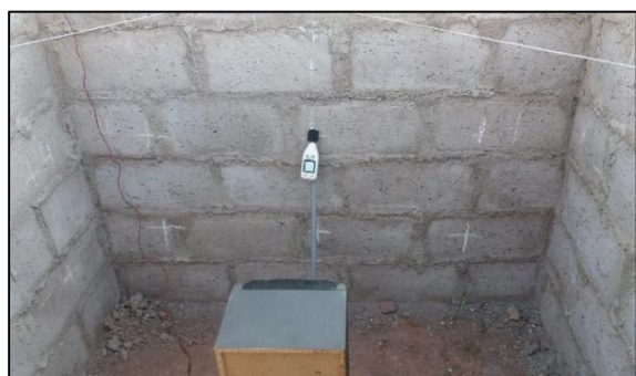
Lectura de sonido en las paredes interiores, con sonómetro digital.
