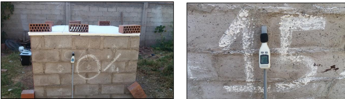
Foto 29. Toma de datos en la pared exterior de los muros
