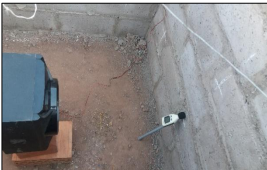
Lectura de sonido en las paredes interiores, con sonómetro digital.
