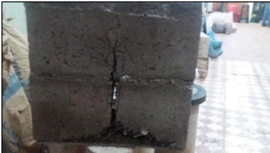
Grieta vertical con desmoronamiento en la base, exactamente en la parte central.
