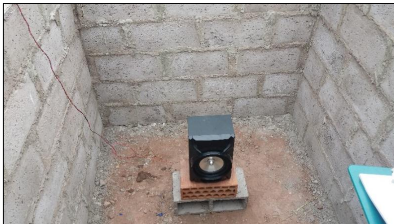
Foto 26. Ubicación del aparato de sonido para las pruebas acústicas
