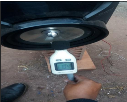
Lectura del sonido patron en el punto medio del prototipo.
