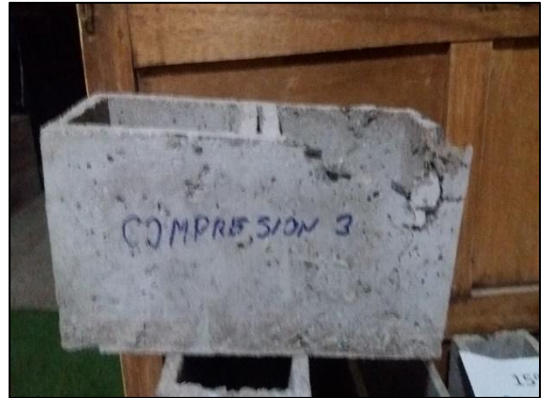
Descascaramiento parte central.
