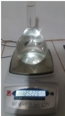
Peso de agua + picnómetro. Peso de agua + muestra + picnómetro.
