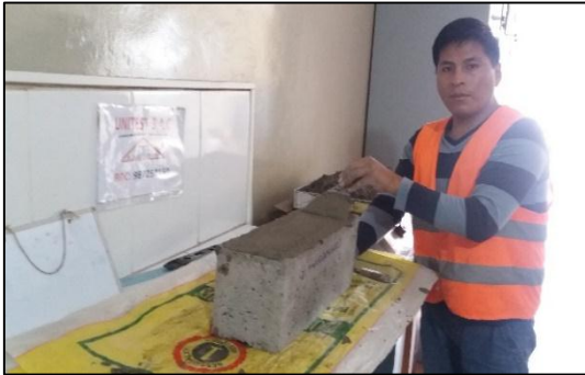
Refrentado de bloques con caping.
