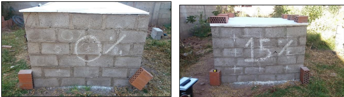
Foto 25. Ubicación y marcado de puntos para las pruebas acústicas
