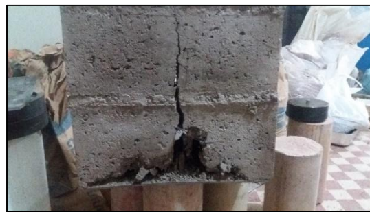
Grieta vertical con desmoronamiento en la base, exactamente en la parte central.
